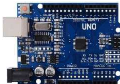
Fig.3 : Shows Arduino UNO Microcontroller
