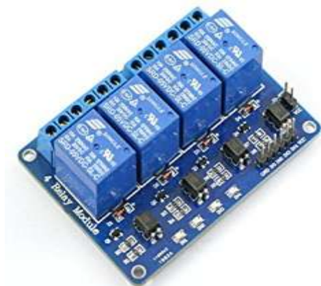
Fig 4(d) Relay module
